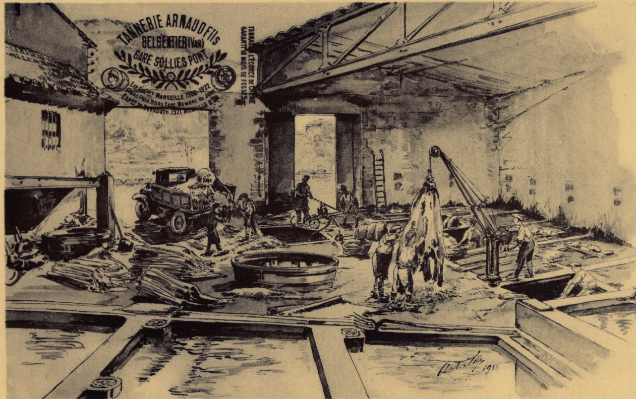
TANNERIE ARNAUD FILS - Belgentier (Var) UNE DES COURS DES FOSSES LES CUIRS SONT TANNÉS AUX ÉCORCES DE CHÊNE ET SÉJOURNENT AU MINIMUM 18 MOIS EN FOSSE
