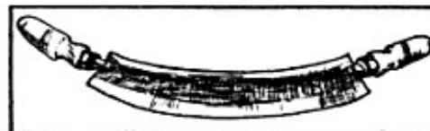
FIGURE 16. - Couteau à écharner à deux manches. Le côté concave de la lame est utilisé pour gratter; le côté convexe, très tranchant, sert à couper.
