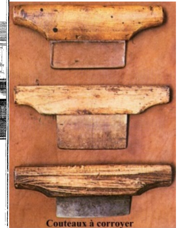
Haut : lame de verre Au centre : : lame de pierre Bas : lame en acier
